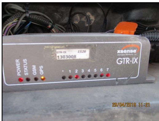
ภาพที่ 2.26 ระบบ GPS ตรวจสอบเส้นทางและ การใช้ความเร็วของรถบรรทุก สินค้าของโครงการ
