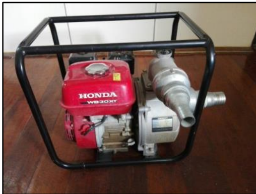
ภาพที่ 2.52 เครื่องปั้มน้ำพร้อมสายยางสำหรับดูดน้ำและสายยางสำหรับฉีดน้ำดับเพลิง ภายในเรือลำเลียงสินค้า
